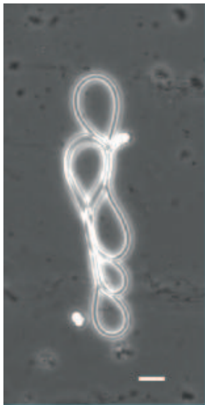
強い磁場下では、リン脂質からなるベシクルチューブは、磁場に平行に配向する。チューブと拮抗する磁場配向性を持つコラーゲンを封入すると、磁場の効果が抑えられ、チューブの曲げの効果が顕在化し、“エラストイカ”と呼ばれる奇妙な曲線構造が産み出される。
